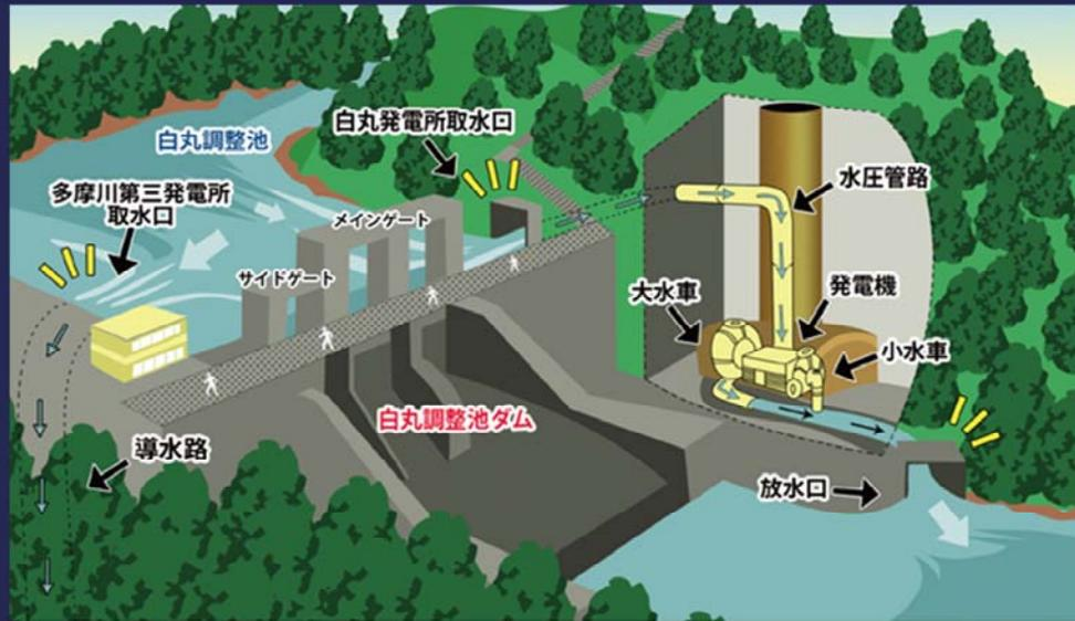
地下式の白丸発電所と白丸調整池から導水路を通じて、約5km下流にある青梅市御岳の多摩川第三発電所の2つの発電所のためにできた「水力発電用」ダムです。
